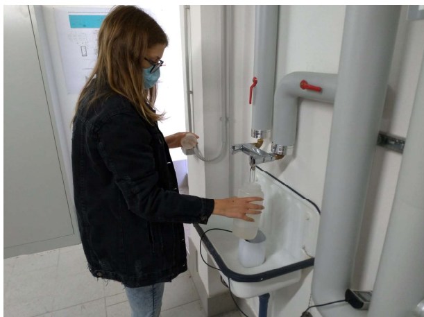
Fig 5 – misura temperatura e prelievo campione da lavabo di servizio stazione termica
